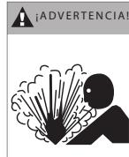
Presión peligrosa. No haga funcionar la bomba contra una descarga cerrada. Libere toda la presión del sistema antes de trabajar en algún componente.
