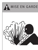
Pression dangereuse. Ne pas faire fonctionner la pompe lorsque l'orifice de purge est fermé. Purger le système de toute pression avant de procéder à l'entretien de tout composant.
